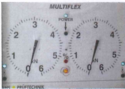
Prüfstand arbeitet im Automatik-Modus und beide Prüfrollen werden in Fahrtrichtung angetrieben.
