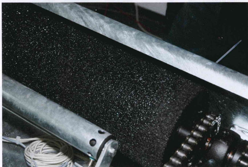
Die Prüfstandsrollen müssen einen Durchmesser von 200 mm und eine Beschichtung mit definiertem Reibwert haben
