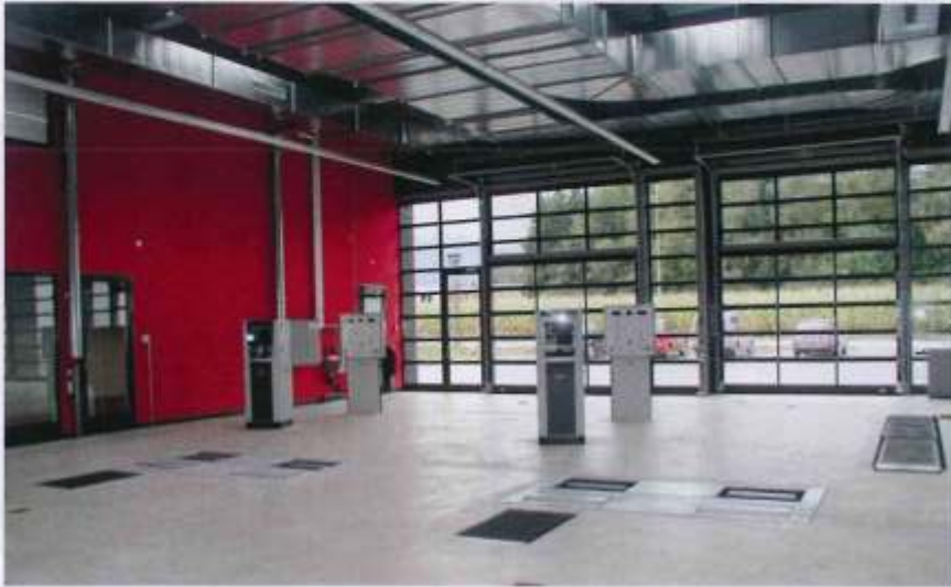
Mehrere AHS-Prüfstraßen nebeneinander, wie sie hauptsächlich große Werkstätten und Prüfstellen einsetzen
