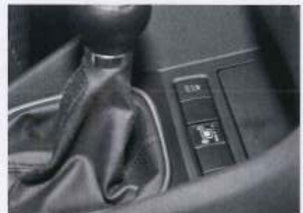
Ebenfalls Standard ist eine an das Innenraumdesign des Fahrzeugs angepasste Füllstandsanzeige für den Gastank
