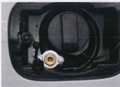
Zum standardisierten Einbau gehört, dass der Einfüllstutzen für den Gastank neben dem normalen Tankstutzen ...
