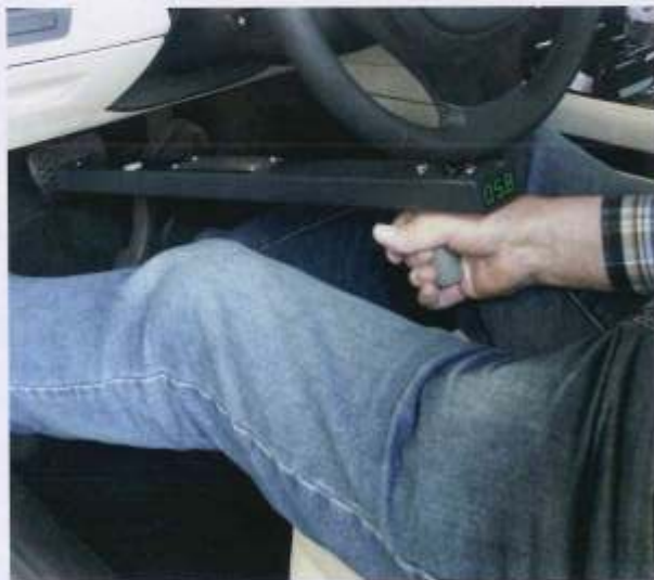
Der AHS Pedalkraftmesser Pedalo 2010 wird direkt auf das Bremspedal aufgesetzt
