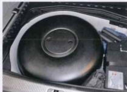
... und der Gastank sicher in der Reserveradmulde verbaut werden
