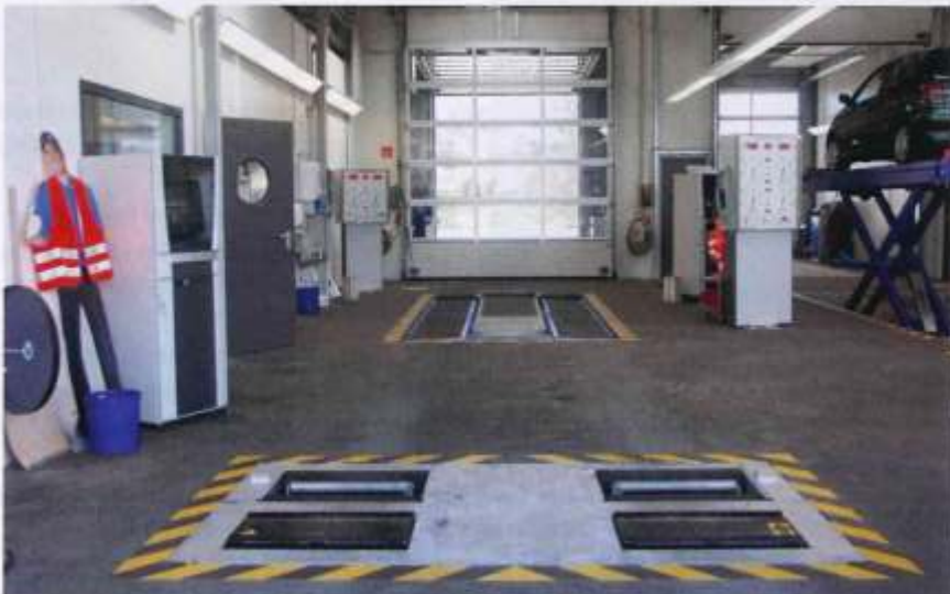
Diese Prüfhalle ist mit Rollenbremsprüfstand, Fahrwerkstester und großen Multiline-Anzeigeelementen ausgestattet
