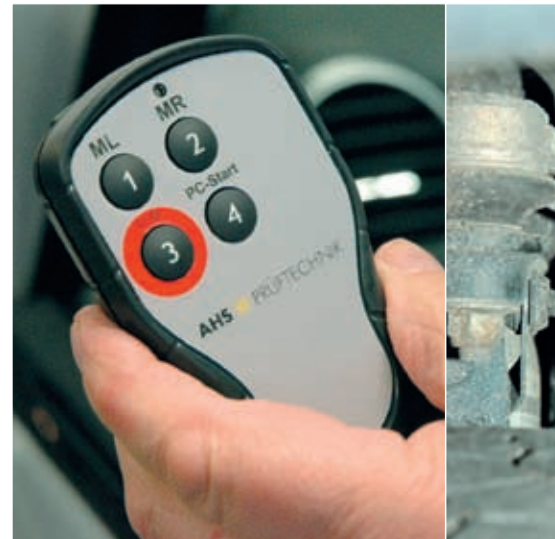
Mit einer Fernbedienung werden Funktionen wie das Einschalten des Gegenlaufs gesteuert
