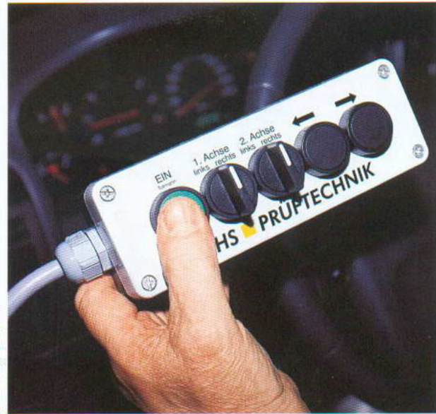
Mit dieser Kabelfernbedienung wird der komplette Allradbremsenprüfstand gesteuert
