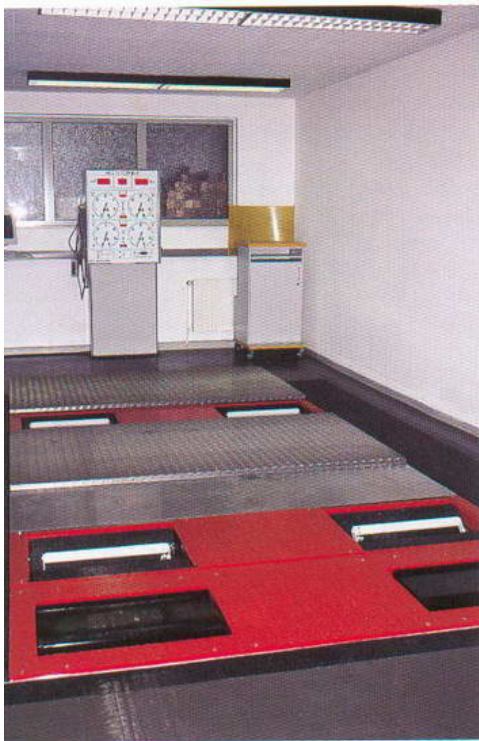
Der Multiflex 4x4 mit dem vorderen verfahrenen Rollensatz, hier zusätzlich in Kombination mit einem Fahrwerkstester
