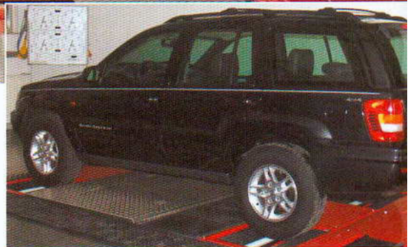
Der Bremsenprüfstand Multiflex 4x4 mit verschiebbarem Rollensatz
